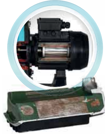
izolasyonlu motor sargı kesiti Stator kesiti
